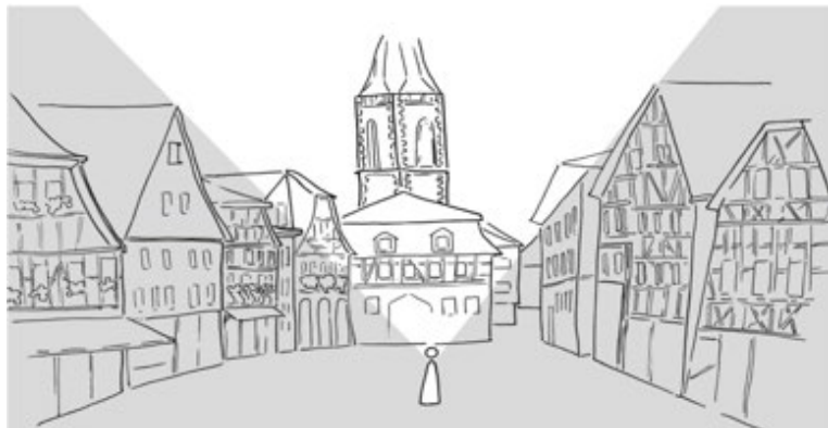
Abbildung 28: Schematische Darstellung der Baulich-Räumlichen Offenheit (SkyView-Faktor). Der SVF wird durch einen Wertebereich zwischen Null (vollständige Geschlossenheit) und Eins (vollständige Offenheit) beschrieben.
