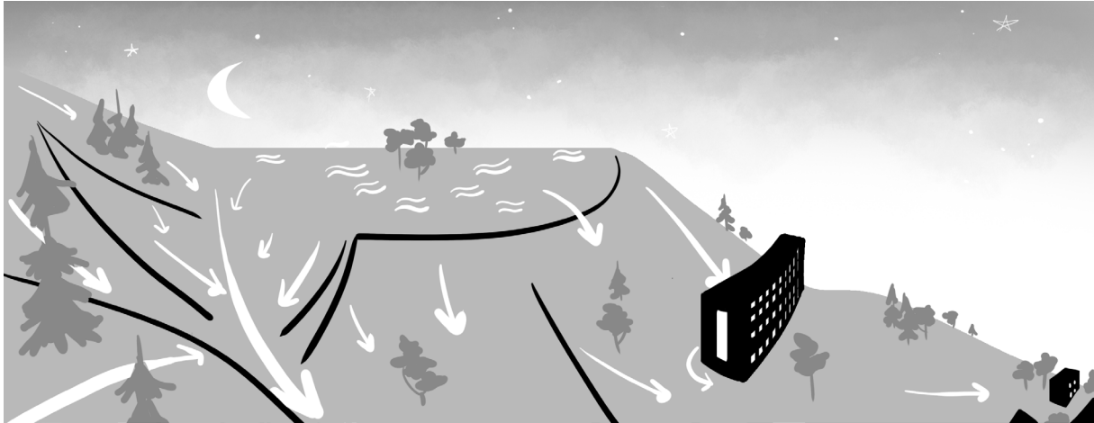
Abbildung 6: Schematische Darstellung eines der Orographie folgenden Kaltluftabflusses (helle Pfeile). Ähnlich einer Flüssigkeit versucht die Kaltluft Hindernisse wie bspw. Gebäude zu umströmen. Orthogonal zum Kaltluftstrom ausgerichtete größere Hindernisse, wie bspw. Gebäuderiegel (rechts) bremsen bzw. stauen die Kaltluft.
