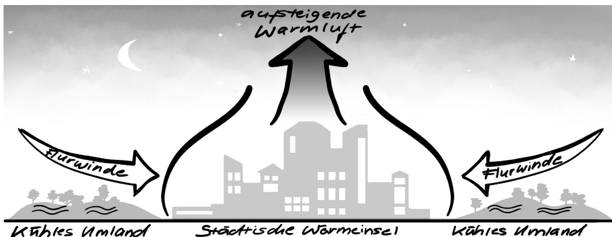
Abbildung 5: Darstellung eines Flurwindsystems am Beispiel des Stadt-Umland-Windsystems. Während einer strahlungsarmen Nacht steigen die wärmeren "Stadtluft"-Massen auf (geringere Dichte) um nach Abkühlung (höhere Dichte) wieder abzusinken. Zusammen mit den nach Sonnenuntergang entstehenden Kaltluftmassen des ruderalen Raums etabliert sich so ein sensibles Flurwindsystem (Sogwirkung durch den Luftdruckgegensatz).
