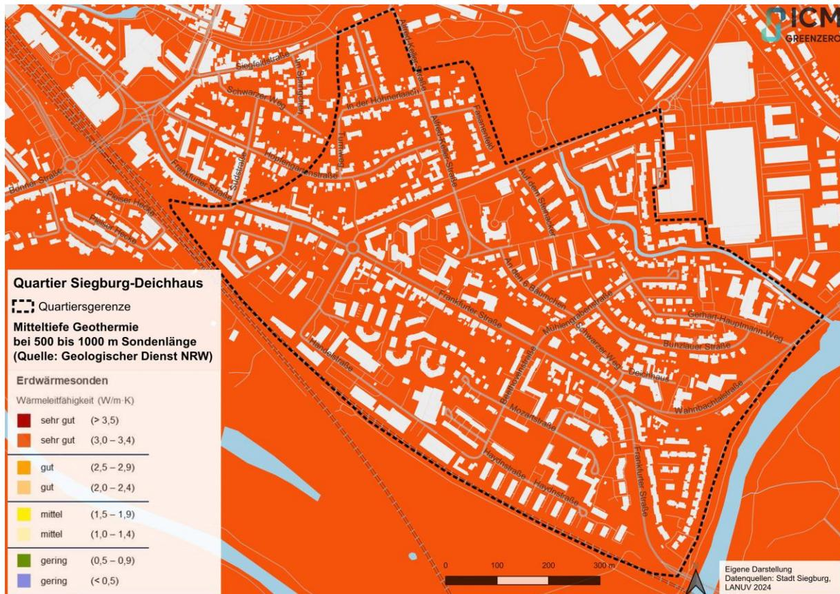
Abbildung 76: Mitteltiefe Geothermiepotenziale bei einer Sondenlänge von 500 bis 1.000 Meter in W/mK
