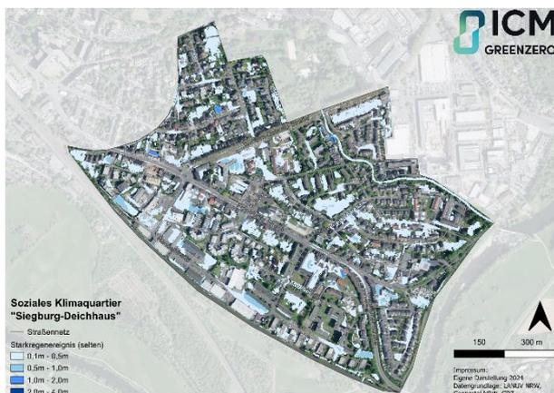
Abbildung 49: Überflutungshöhen bei einem seltenen Starkregenereignis. (Eigene Darstellung 2024)
