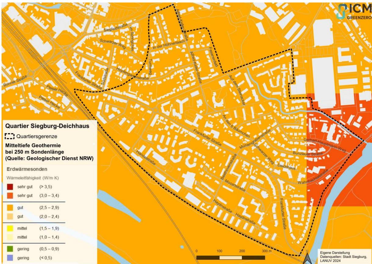
Abbildung 75: Mitteltiefe Geothermiepotenziale bei einer Sondenlänge von 250 Meter in W/mK
