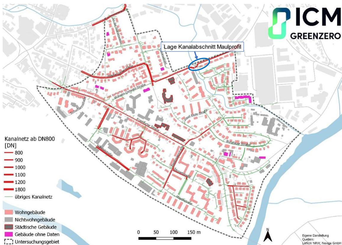
Abbildung 77: Kanalnetz im Quartier Deichhaus, rot hervorgehoben, Kanalquerschnitte > DN800. (Quelle: Eigene Darstellung)
