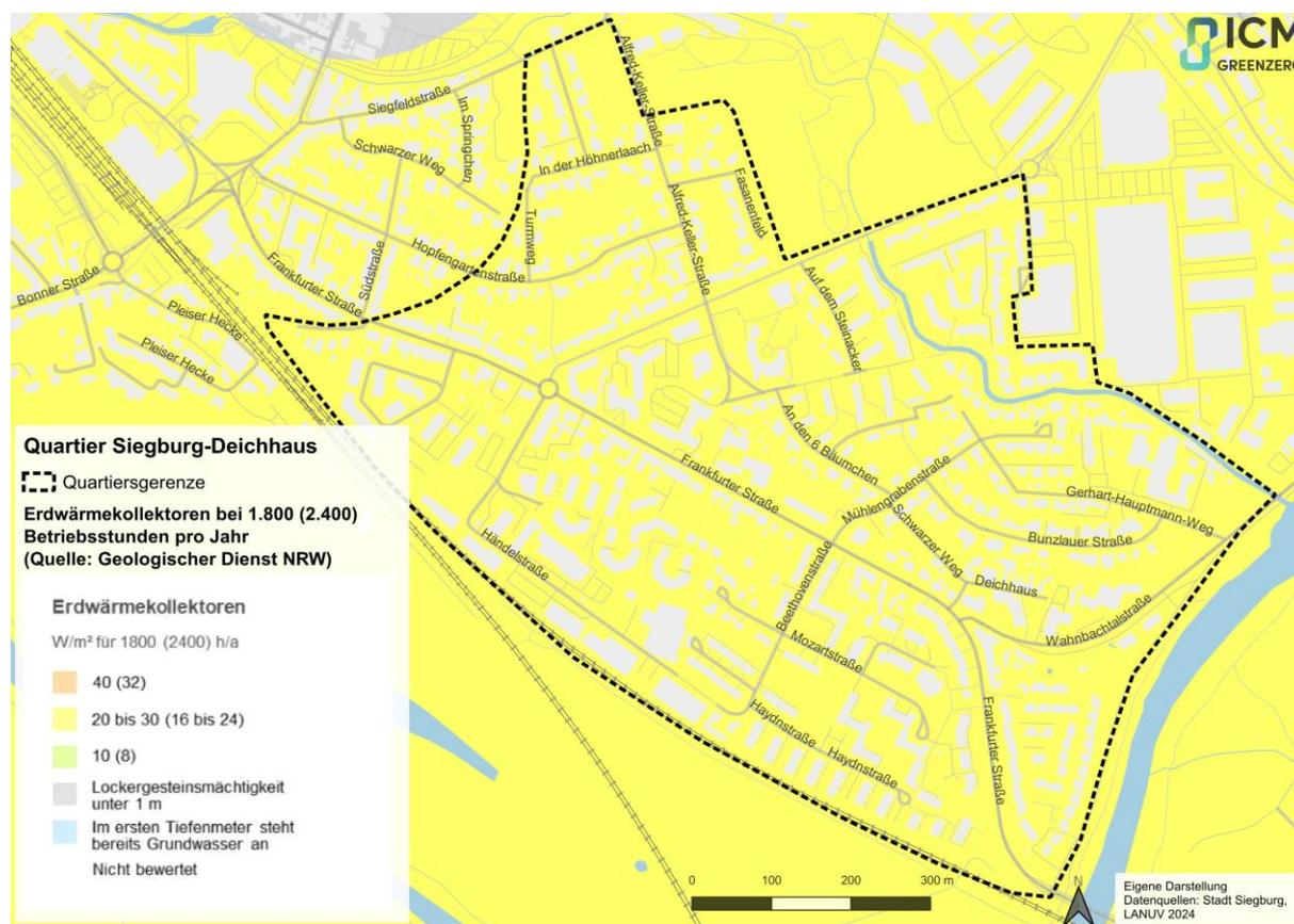
Abbildung 72: Darstellung der Entzugsleistung von Erdwärmekollektoren in W/m<sup>2</sup>
