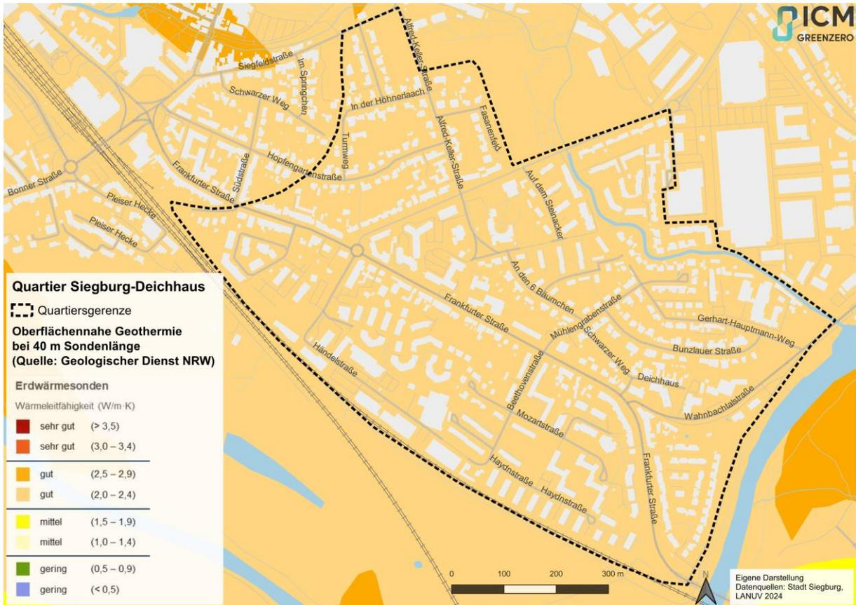
Abbildung 73: Geothermiepotenziale bei einer Sondenlänge von 40 Meter in W/mK
