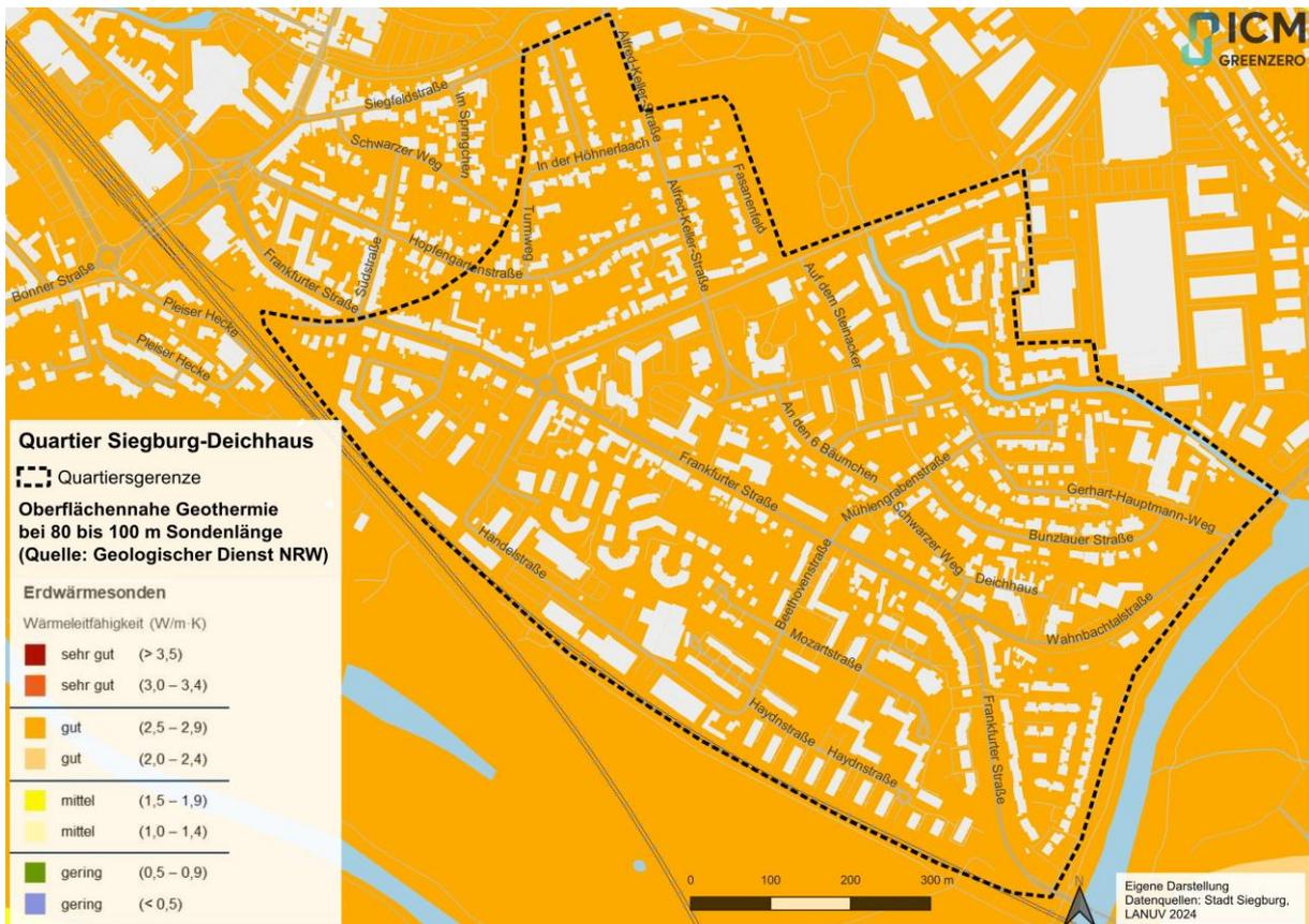
Abbildung 74: Geothermiepotenziale bei einer Sondenlänge von 80 bis 100 Meter in W/mK
