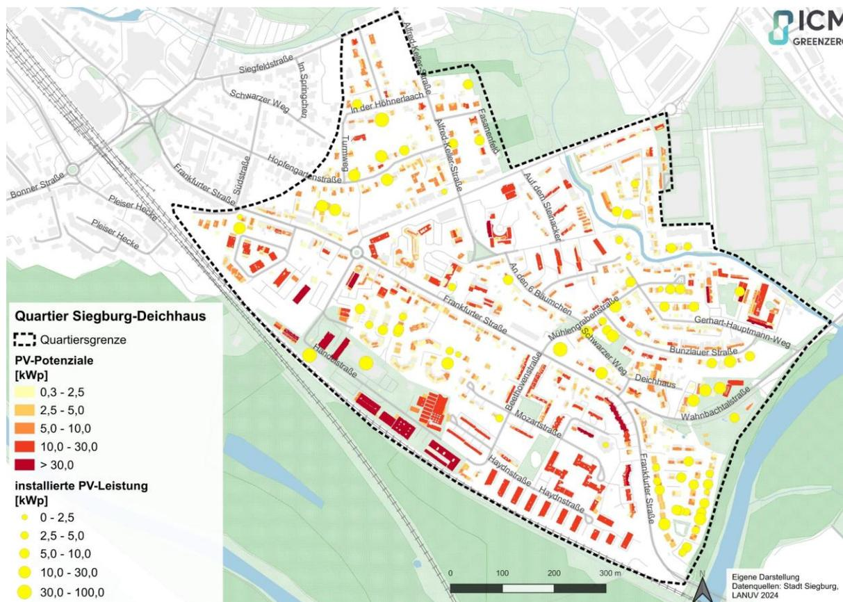
Abbildung 71: Darstellung der räumlichen Verteilung des theoretischen PV-Aufdach-Potenzials mit den aktuell installierten PV-Anlagen
