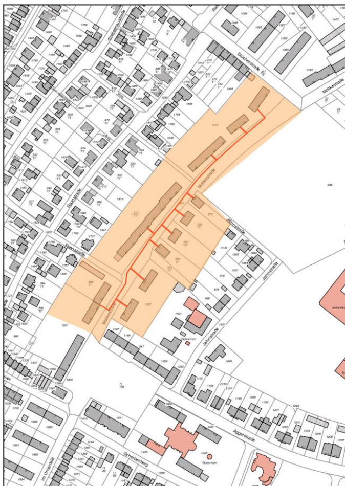
Abb. 82: Lageplan eines Nahwärmenetzes im Bereich der Moltkestraße
