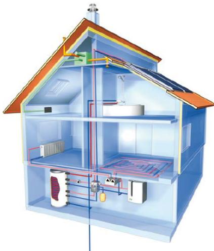
**Haus 4** Wie Haus 3, zusätzlich kontrollierte Wohnungslüftung mit Wärmerückgewinnung und Sanierung der Gebäudehülle entsprechend KfW-Effizienzhaus-100-Standard.
