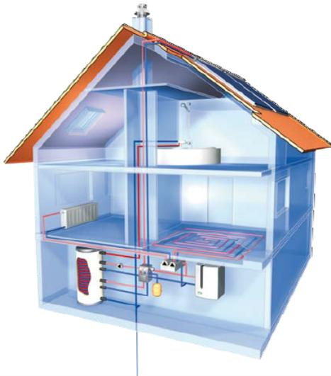
**Haus 3** Moderner Brennkessel (Öl/Gas), solare Trinkwassererwärmung und Heizungsunterstützung, Anpassung der Heizflächen, geregelte Pumpen, neue Thermostatventile, Dämmung der Verteilleitungen, hydraulischer Abgleich, Sanierung der Abgasleitung.
