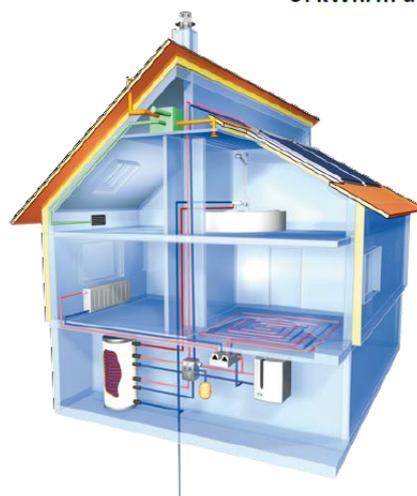
**Haus 5** Wie Haus 3, zusätzlich kontrollierte Wohnungslüftung mit Wärmerückgewinnung und Sanierung der Gebäudehülle entsprechend KfW-Effizienzhaus-70-Standard.
