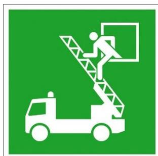
Im **Außenbereich** sollte sobald eine größere Anzahl von Personen auf das Rettungsfenster angewiesen sind im Einzelfall eine zusätzliche Kennzeichnung angebracht werden. Diese dient den Einsatzkräften bei der Erkundung frühzeitig eine Anleiterstelle ausfindig zu machen. Die Kennzeichnung ist nach DIN 14034-6 zu wählen.
