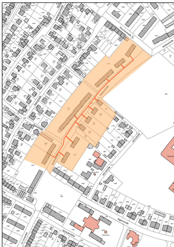
Abb. 82: Lageplan eines Nahwärmenetzes im Bereich der Moltkestraße
