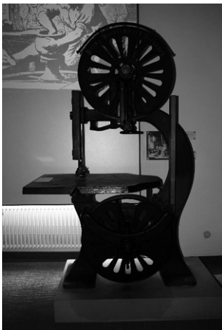
Holz-Bearbeitungsmaschine, Hochleistungs-Sägegatter aus der Maschinenfabrik und Eisengießerei „Prinz-Heinrich-Werk“ in der Hopfengartenstraße
